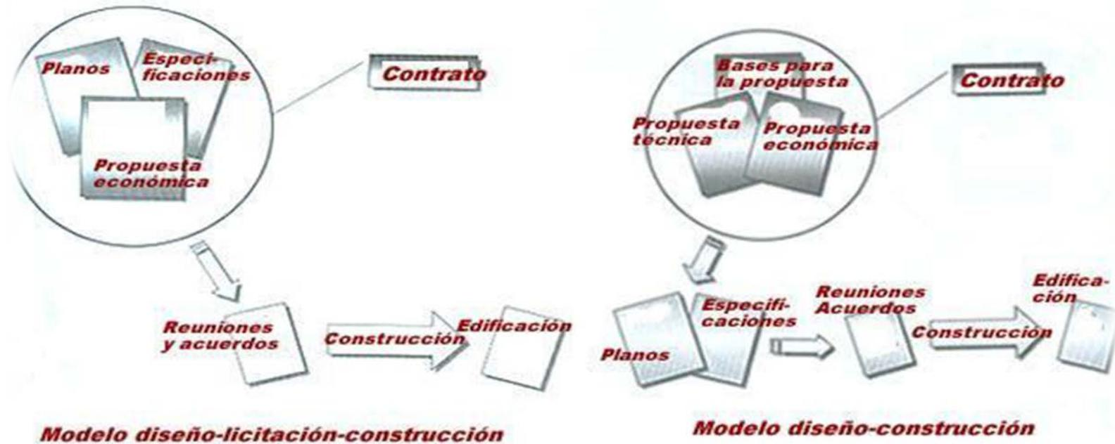
**Figura 1. Diferencia entre el modelo diseño-licitación-construcción y el modelo diseño-construcción**
