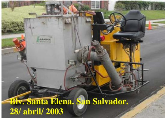
A.1) Máquina Franjeadora Autopropulsada, para la aplicación de pintura Termoplástica (método de Extrusión).
