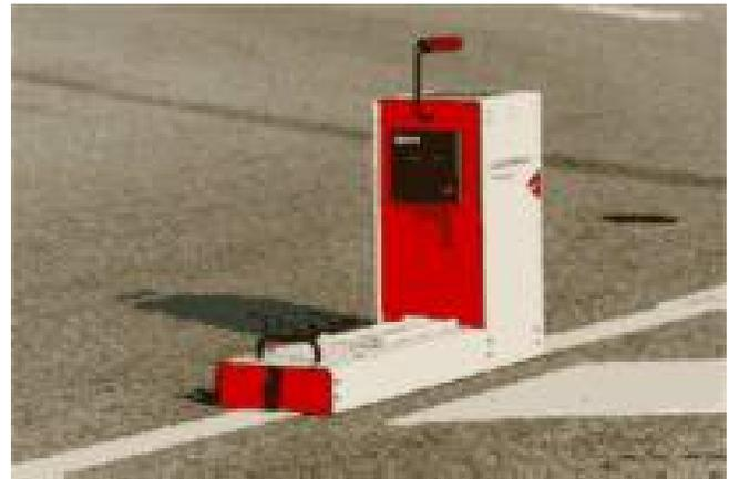
Figura 7.3 Retroreflectómetro Portátil.<sup>5</sup>
