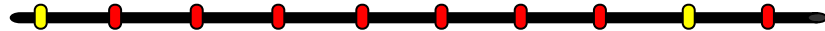
a) Esquemas de las marcas en los cables eléctricos. (En inclinómetros de sistema métrico, las marcas rojas distan cada 0.5m y las amarillas cada 5m)
