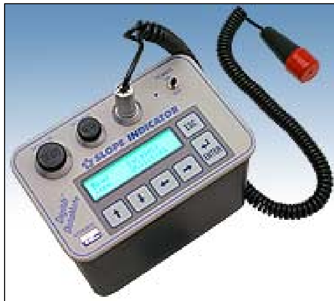
Figura 3.3. Unidad lectora portátil, utilizada para la recolección de las desviaciones de los pozos inclinométricos. [Propiedad del Ministerio de Obras Públicas]
