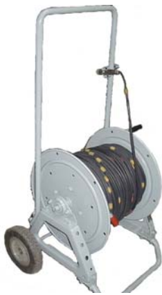
b) Carrete para el almacenaje del cable eléctrico
