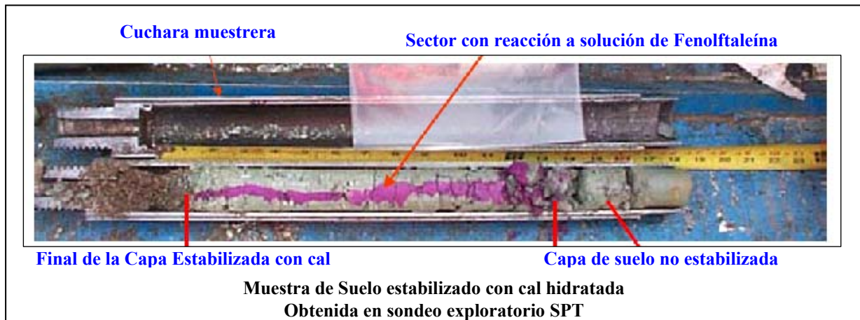
Fotografía 7: Aplicación de Fenolftaleína en Suelo Estabilizado con Cal Hidráulica, en muestra de suelo obtenida a través de sondeo exploratorio SPT. [Figura modificada del documento Reporte de investigación KTC-05-01/SPR 270-03-11 de la Universidad de Kentucky]
