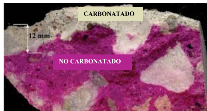
Fotografía 3: Profundidad de carbonatación de una superficie de concreto recién fracturada, luego de la aplicación de una solución de fenolftaleína.
