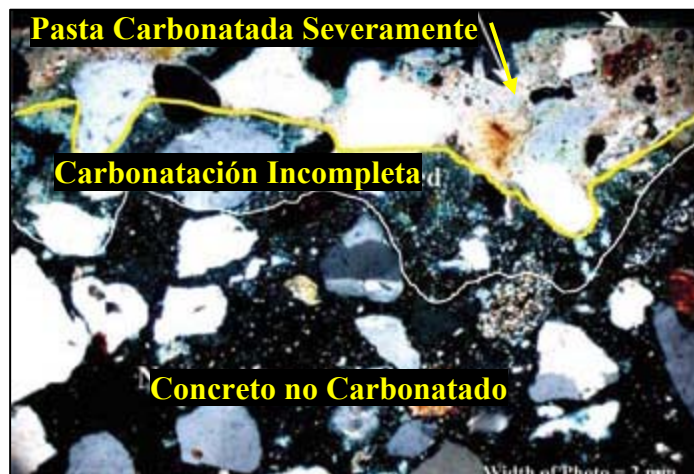
Figura 2: Profundidad de carbonatación de una sección de concreto, usando microscopio petrográfico.
