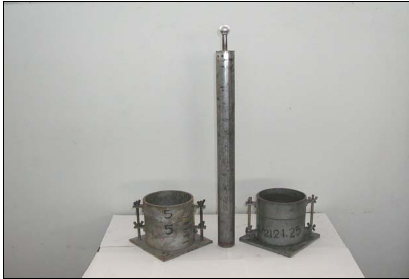
Fotografía 2. Equipo para ensayo ASTM D 1557 (Standard Test Methods for Laboratory Compaction Characteristics of Soil Using Modified Effort).
