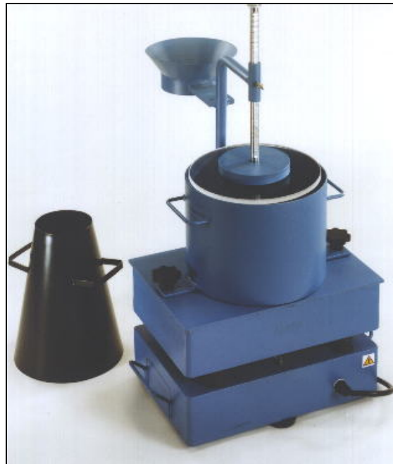
Fotografía 1. Consistómetro Vebe, descrito en ACI 211.3.
