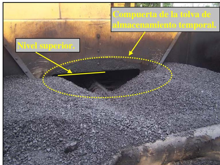
**Fotografía 5.** Mezcla asfáltica abajo del nivel superior de la compuerta de la tolva de almacenamiento temporal.
