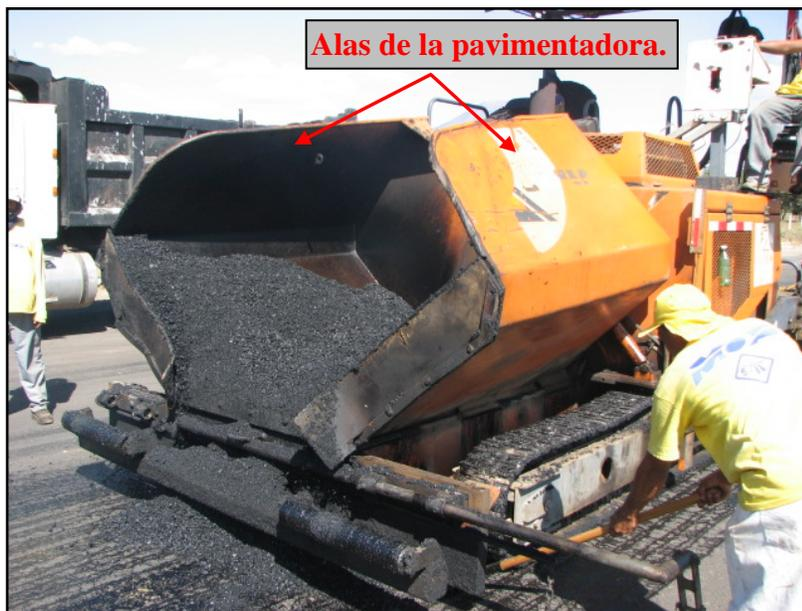
**Fotografía 8.** Tolva de almacenamiento temporal de la pavimentadora con las alas cerradas.
