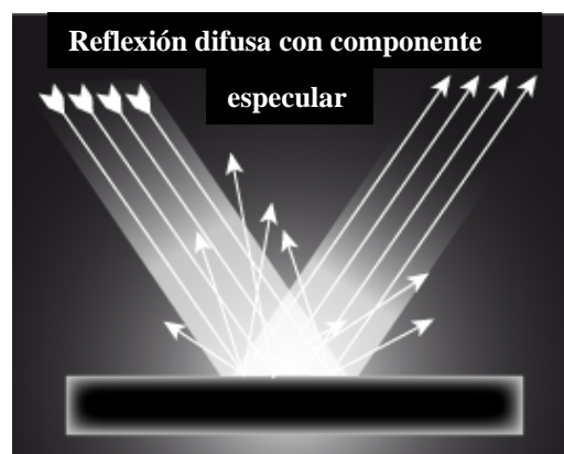
Figura 1c. Combinación de efectos de reflexión, Reflexión Difusa y Reflexión especular [Figuras 1a, 1b y 1c modificadas del documento Reflexión, www.gusgsm.com ]
