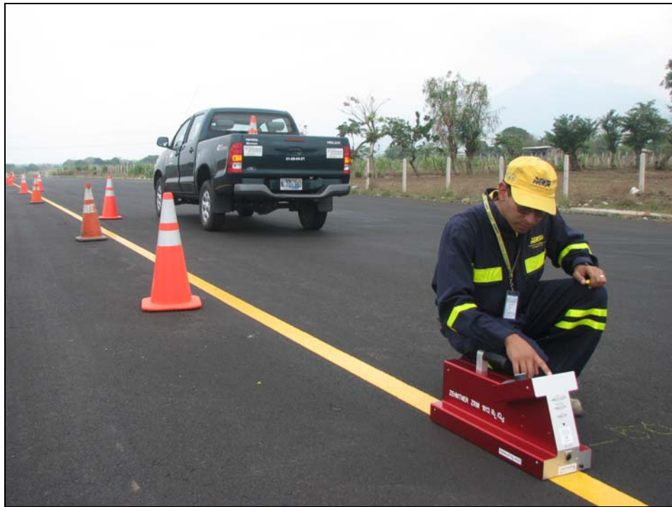
Fotografía 3. Ejecución de ensayos para la medición de la retroreflectividad utilizando un Retroreflectómetro Zehntner ZRM 1013 R_L/Q_d propiedad de la UIDV-VMOP. [Ministerio de Obras Públicas de El Salvador, By Pass de la ciudad de Usulután]
