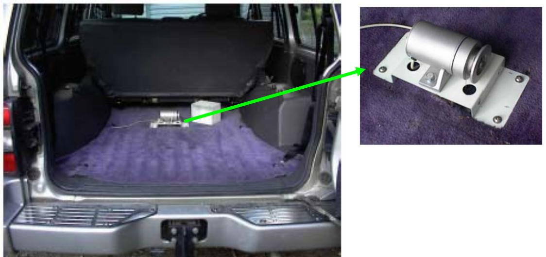
**Figura 4. Equipo Tipo Respuesta (Bump Integrator, BI)**
