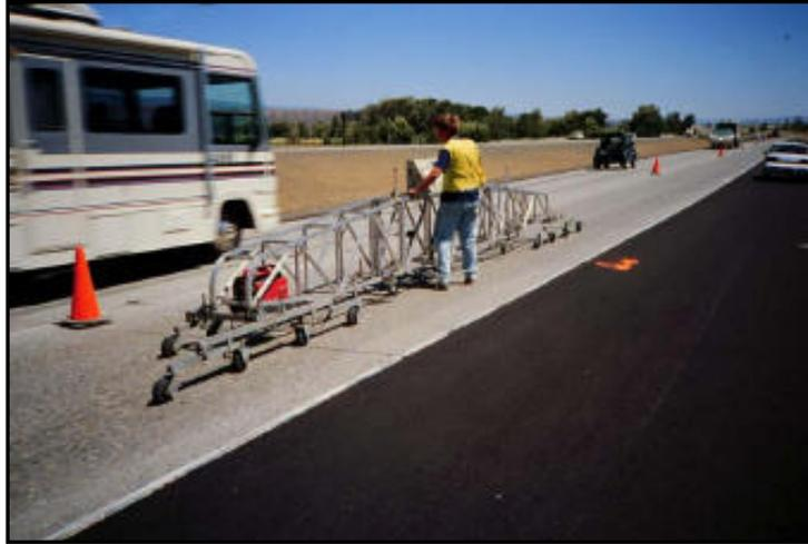
**Figura 2. Perfilógrafo de California**
