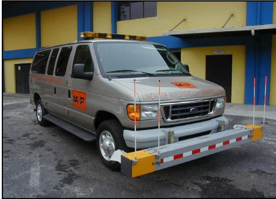
**Figura 9. Perfilómetro Inercial**
