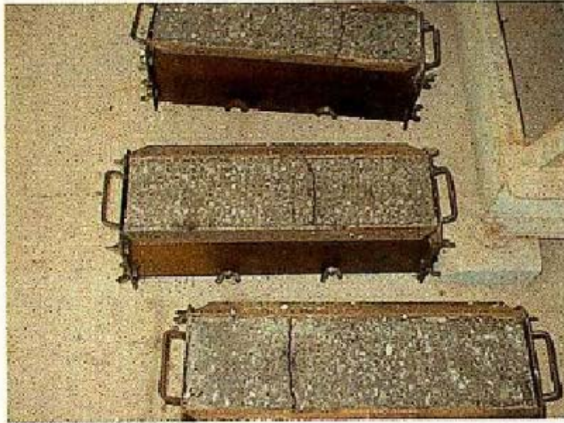
Foto 1: Vigas de Suelo-Cemento Fluido, 6.82% de Materia Orgánica
